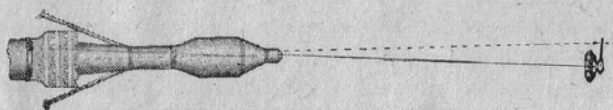
Sl. 26. — Gađanje tenka (oklopног vozila) iz ručnog bacača sa uzimanjem jednog preticanja (prvim levim zarezom), a nišanom »1«
